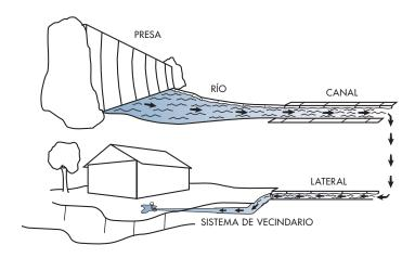
De ahí, el sistema que lleva el agua a tu propiedad se compone de zanjas, tuberías, puertas de control y válvulas. Este sistema pertenece a las personas que utilizan el sistema de riego de tu vecindario, por lo que todos ustedes, son responsables del mantenimiento y operación del mismo.
